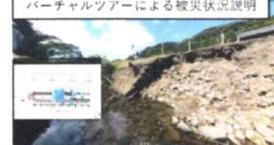
ドローン測量で取得した点群データから被災箇所の3次元モデルを作成し、設計図面を作成
